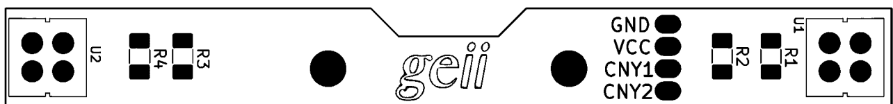
figure 15 : schéma d'implantation bottom de la carte « CNY_dual_v3 »
