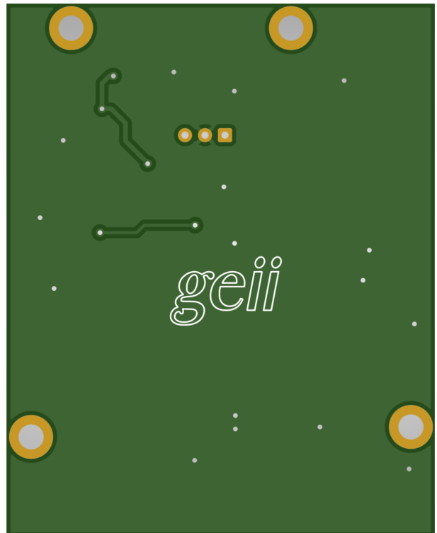
figure 8 : Modèle de la face bottom de la carte « Robot Mini-Sumo »
