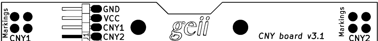
figure 16 : schéma d'implantation top de la carte « CNY_dual_v3 »
